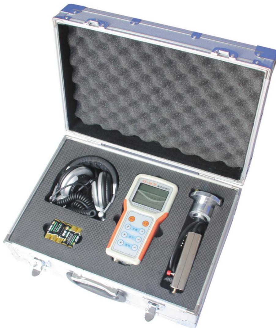
感谢您选择使用ST-16C型漏水检测仪。本仪器是一台具有高度稳定性、结构轻巧携带方便、操作简单、信噪比高的地下管道漏水探测设备。其工作原理将暗埋管道漏水点所产生的震动信号通过换能器（传感器、探头）转换成电信号传送到仪器主机，通过主机滤波放大来准确探测漏点的位置。
