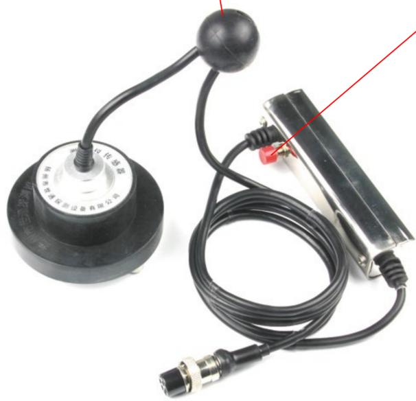
手柄开关（图）：按下**手柄红色开关按键**，此时传感器接收的信号传送到仪器，反之松开红色按键及断开信号传送。注：探测时探头放在管道上方地面稳定后按下手柄按键，挪动探头时松开手柄按键，避免传感器落地时受到震动耳机声音过大刺激耳膜。频段选择2-4米低频，0.5-3米选中频，0.2-1米高频（仅供参考）。
